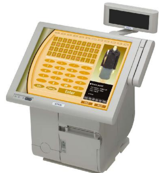
Die vertikale Variante spart noch mehr Platz und ist optional auch später noch nachrüstbar. Der Bon kommt dabei dem Bediener entgegen.
