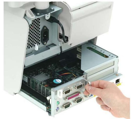
Speicher erweitern oder CompactFlash einsetzen? Kein Problem mit dem Motherboard als Schublade.
