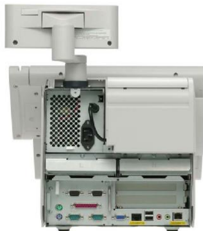
Ein Blick auf die vielen Schnittstellen für Peripherie (ohne Abdeckung)
